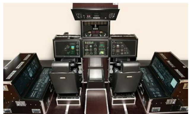
Rys. 8. Widok wybranego elementu symulatora diagnostycznego statku powietrznego zrealizowanego w ITWL
