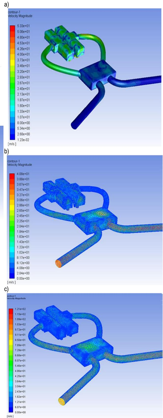
Fig. 3. Distribution of total velocity values a)  $v_p = 0 \text{ m/s}$ ; b)  $v_p = 36 \text{ m/s}$ ; c)  $v_p = 94 \text{ m/s}$
