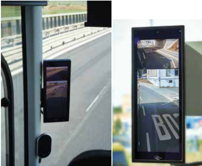
W systemie OptiView klasyczne lustra zostały zastąpione monitorami LED umieszczonymi we wnętrzu pojazdu na słupkach „A”
