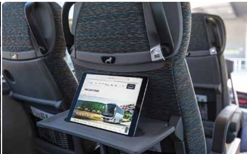
Gniazda USB zostały w pełni zintegrowane z elementami stylistycznymi foteli pasażerskich. Fot. MAN
