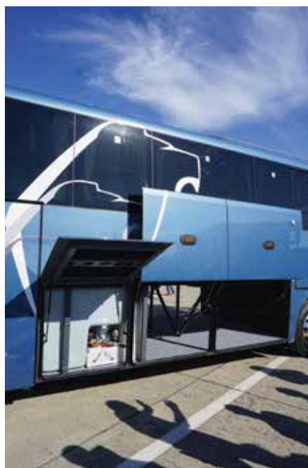
Lion's Coach w wersji C odznacza się największą pojemnością bagażników podpodłogowych, do których dostęp zapewniają pokrywy unoszone na podnośnikach teleskopowych, równoległe do ścian bocznych. Zoptymalizowana kinematyka podnośników pozwala otwierać kłapy jedną ręką, bez konieczności używania dużej siły
