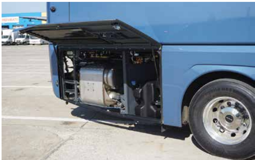
Normę Euro-6 uzyskano dzięki zastosowaniu systemu katalitycznego dopalania spalin SCR, chłodzenia powietrza doładowującego EGR i filtra cząstek stałych DPF
