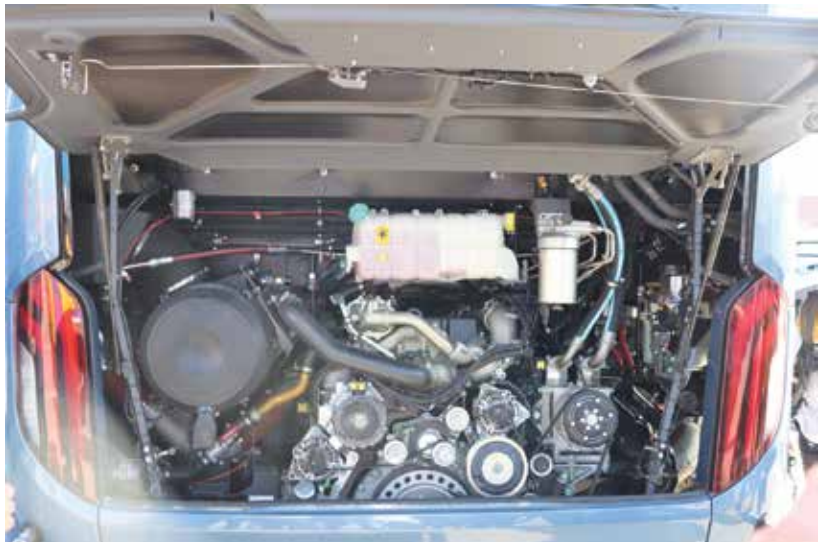
Podobnie jak w autobusach poprzedniej generacji jednostką napędową jest stojący silnik common-rail MAN D2676, spełniający normę Euro-6
