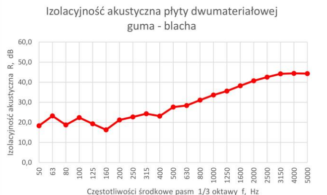
Rys. 6. Izolacyjność akustyczna płyty dwumateriałowej uzyskana w wyniku pomiarów [10]
