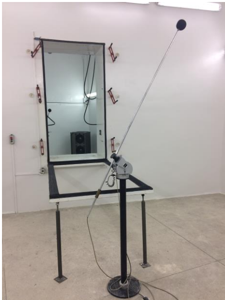
Rys. 5. Widok komory odbiorczej laboratorium Zespołu Komór Pogłosowych Sprzężonych, przeznaczonych do badań izolacyjności akustycznej właściwej [6]
